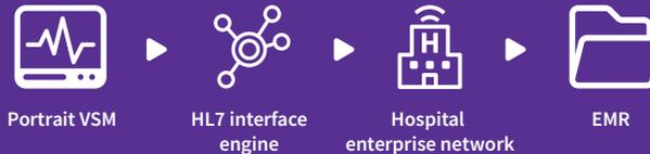
Connettività all'EMR Cerner<sup>™</sup> Millennium<sup>™</sup> tramite CareAware<sup>™</sup> VitalsLink<sup>™</sup> con l'ausilio di un protocollo iBus<sup>™</sup>
